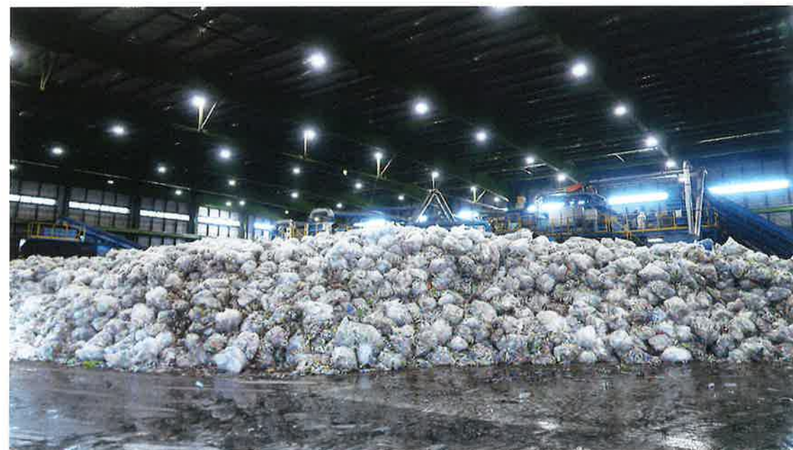
国内最大級の処理能力(日量733.96トン)をもつ近代的な工場建屋内にあるストックヤードは、最大で13トントラック等80台分(110トン)/日を受け入れた
