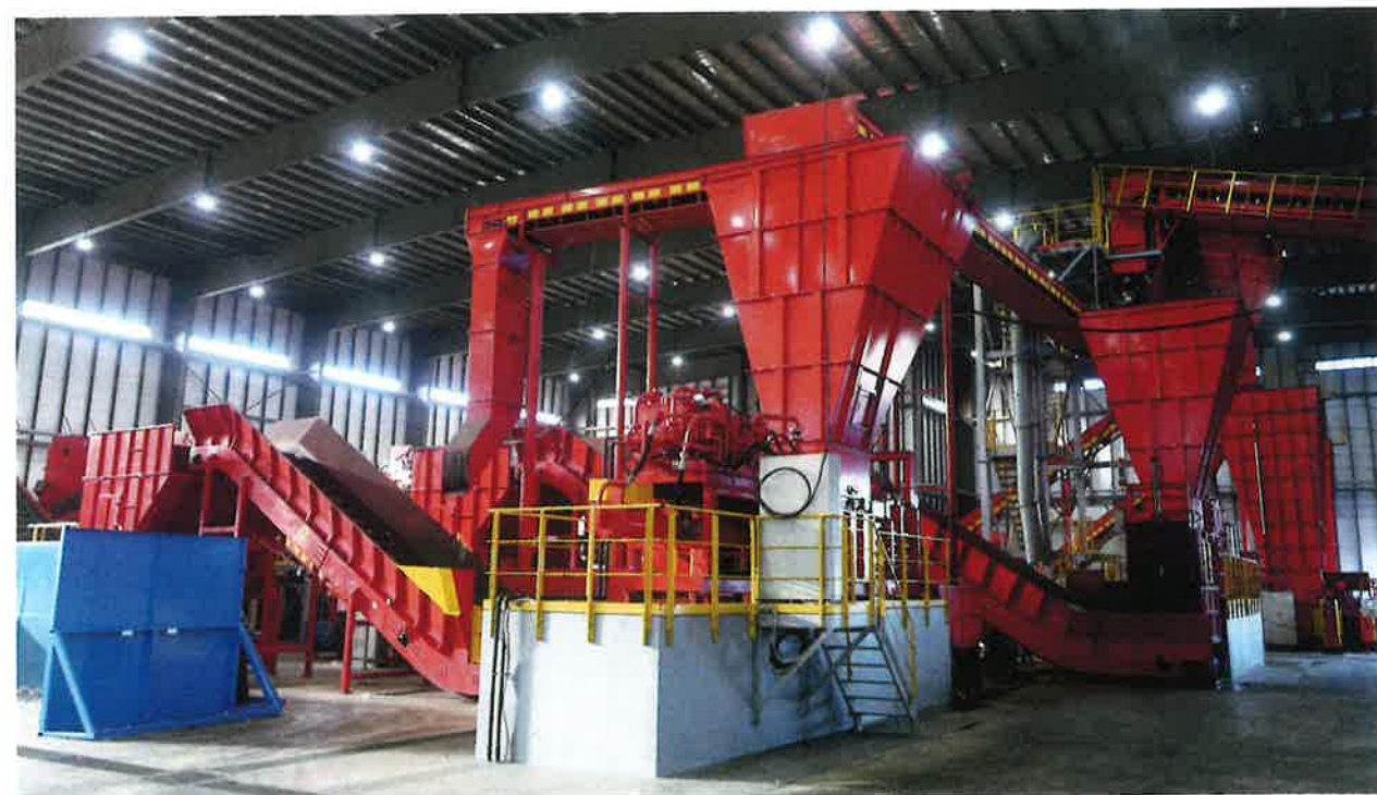
PETボトル自動プレス機。B棟から搬入されたPETボトル等をプレスして選別し易い形状にする。次に解碎機で物をバラバラにし、各選別機に送られる。
