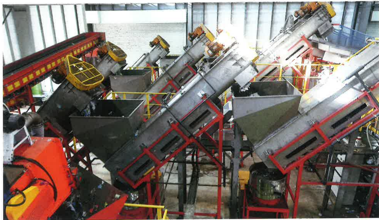
PETボトル洗浄脱水スクリーンコンベア (PETボトルにシャワーリングし、表面の汚れ、ベタつき、臭い等を取り除く) を3連 (9台) で行い、大量のPETボトルを高品質なリサイクル素材にする。
