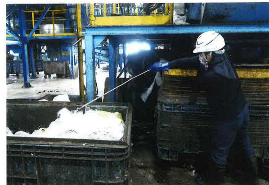
破袋機で破かれたビニールを除袋機で回収した際に、ビニール以外の容器類もビニール側に来てしまう為、風力選別でビニールを吸引してビニールと容器類に分ける。その時に吸引しきれなかった袋を取り除く。
